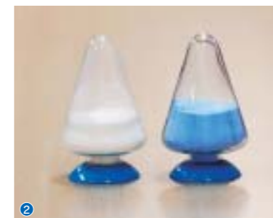
① 垂鉛めっきが施された鋼管柱の、地下に埋設する部分に「PET粉体塗装」が施される ② 新開発の粉体塗料である飽和ポリエステル樹脂。ペットボトルからのリサイクル材を使用することもできる ③ PET粉体塗装の作業工程の一場面
