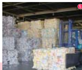
5 回収された古電話帳が、フォークリフトで次々とバルバーに運ばれてゆく 6 厚い電話帳を製本する際に使われている強力な背のりを分離する工程 7 クロズドロープリサイクルの仕組みでできあがった用紙は包装紙に巻かれ、「電話帳本文用紙」として印刷会社に出荷される
