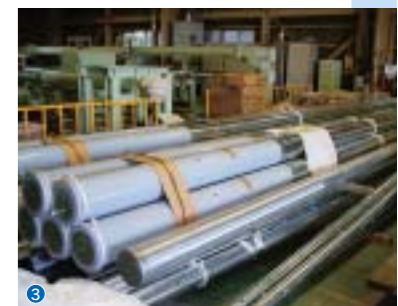
① 垂鉛めっきが施された鋼管柱の、地下に埋設する部分に「PET粉体塗装」が施される ② 新開発の粉体塗料である飽和ポリエステル樹脂。ペットボトルからのリサイクル材を使用することもできる ③ PET粉体塗装の作業工程の一場面
